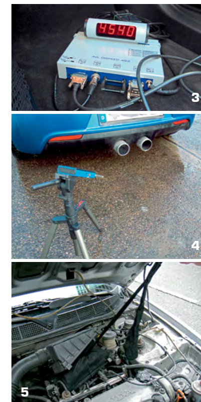
3. Externer Drehzahlmesser bei der Messung eines Pkw 4. Praktischer Aufbau einer Standgeräuschmessung 5. Können bei der Fahrgeräuschmessung entscheidend sein: manipulierte oder unzulässige Luftfilter und BlowOff-Ventile
