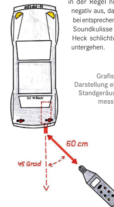
3. Externer Drehzahlmesser bei der Messung eines Pkw 4. Praktischer Aufbau einer Standgeräuschmessung 5. Können bei der Fahrgeräuschmessung entscheidend sein: manipulierte oder unzulässige Luftfilter und BlowOff-Ventile
